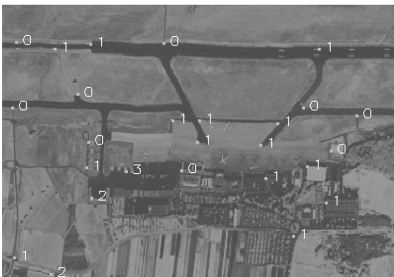
**Abb. 42:** Bildausschnitt (aus dem Zielbild) mit 26 Paßpunkten, die zur Kontrolle der Entzerrung gesetzt wurden. Die Zahlen entsprechen den gerundeten euklidischen Abständen zwischen den korrespondierenden Punkten in Abb. 40 und Abb. 41.
