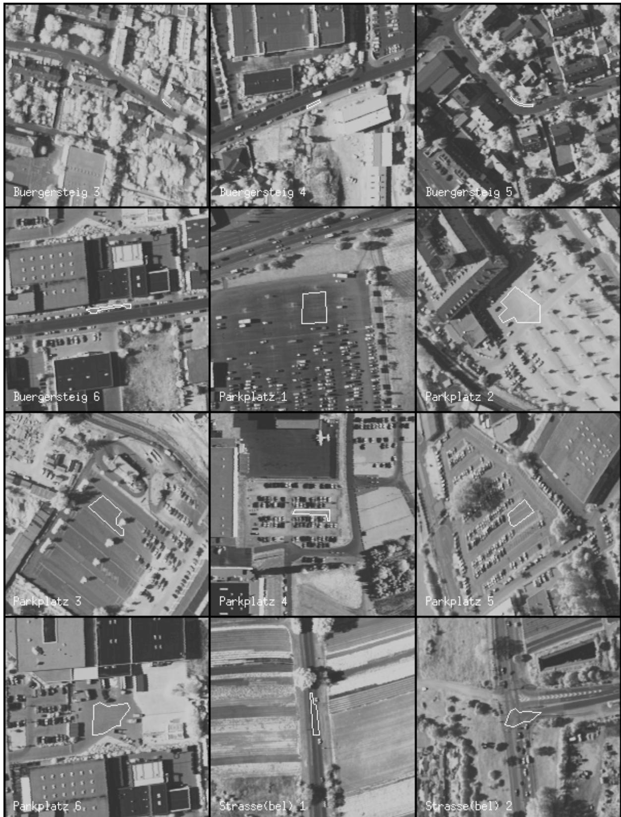
**Abb. A - 16:** Darstellung ausgewählter Stichproben. Die gemittelten Spektren, welche aus den Pixeln errechnet wurden, die von den Polygonen aus weißen Linien umschlossen sind, befinden sich auf der nächsten Seite. Die Bildausschnitte entstammen den Bilddaten des Spektralkanals Nr. 7. Die Bilddaten wurden kontrastverstärkt.
