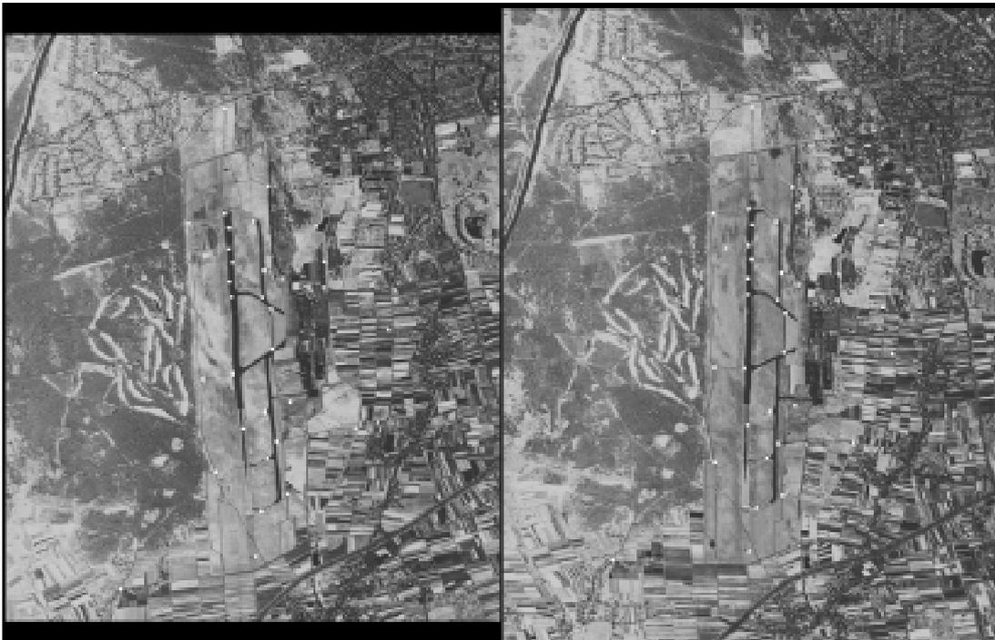
**Abb. 39:** Bildausschnitte aus den Jahren 1991 (links) und 1995 (rechts) mit jeweils 36 markierten Paßpunkten (weiße Flecken). Die Aufnahme erfolgte jeweils aus 1800m Höhe. Beide Bilder sind Panorama-entzerrt und kontrastverstärkt.
