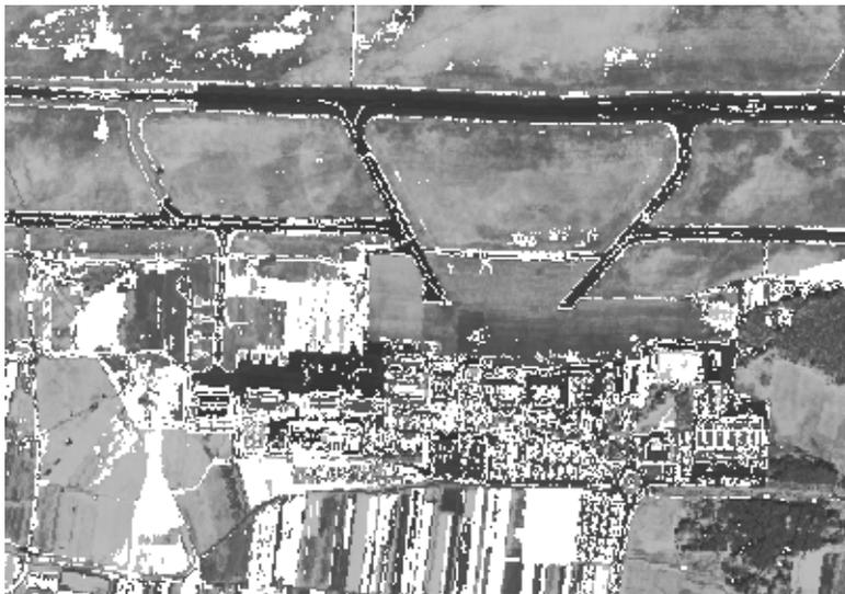
**Abb. 46:** Änderungskarte, die sich aus der Verknüpfung der beiden Klassifikationskarten ergaben, die mit dem „Maximum Likelihood“-Verfahren erzeugt wurden. Die Änderungspixel sind weiß markiert.
