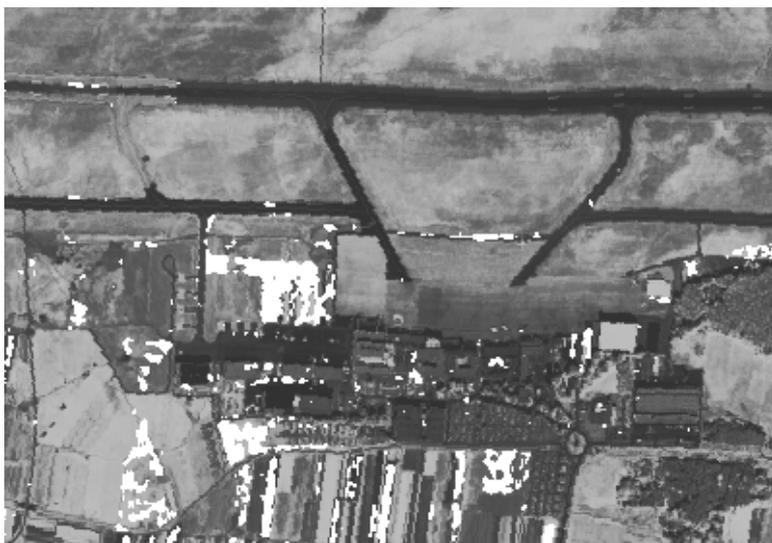
**Abb. 47:** Änderungskarte, die sich aus der Median-Filterung und der logischen Verknüpfung aller vier Klassifikationskarten ergab. Die Änderungspixel sind weiß markiert.
