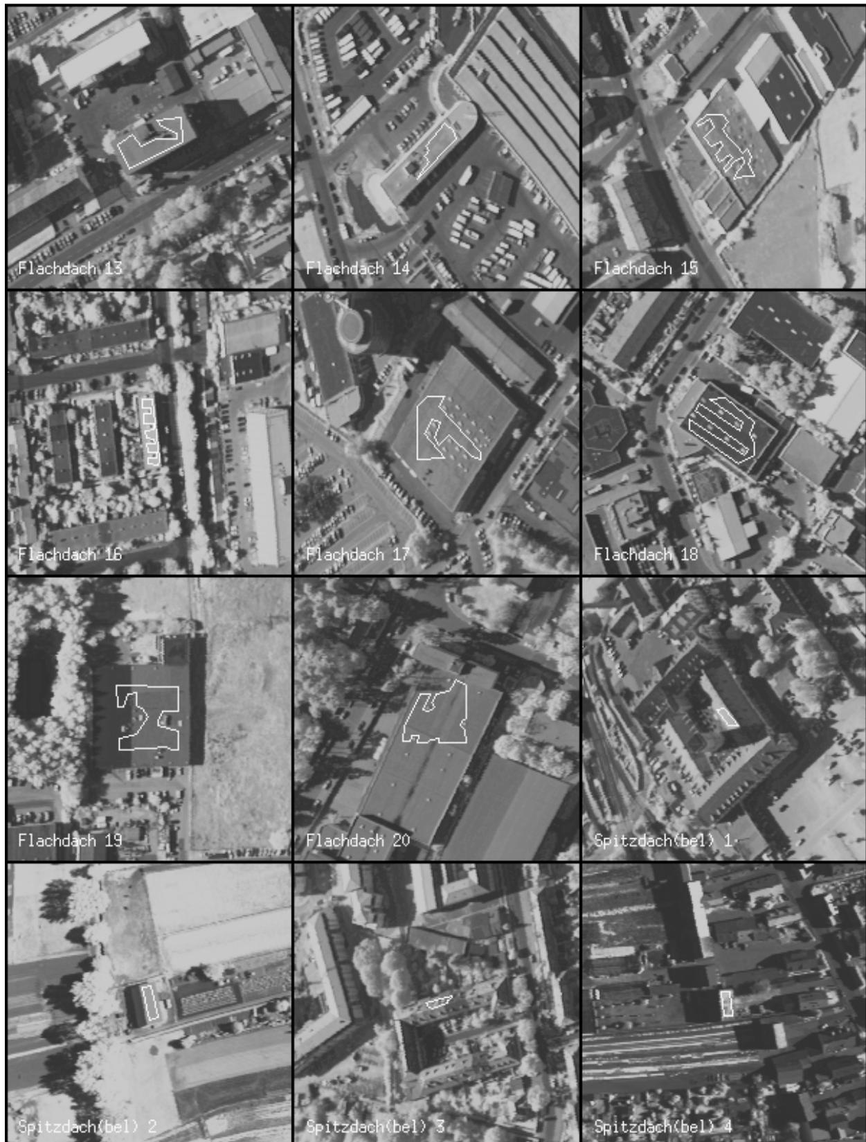
**Abb. A - 10:** Darstellung ausgewählter Stichproben. Die gemittelten Spektren, welche aus den Pixeln errechnet wurden, die von den Polygonen aus weißen Linien umschlossen sind, befinden sich auf der nächsten Seite. Die Bildausschnitte entstammen den Bilddaten des Spektralkanals Nr. 7. Die Bilddaten wurden kontrastverstärkt.
