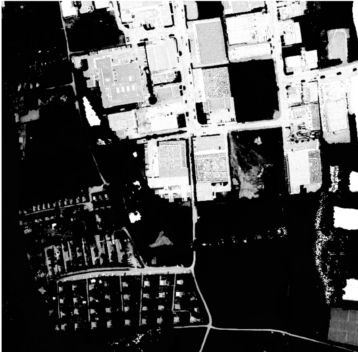
Abbildung 3: Beispiel für die in Multispektralbildern mögliche zuverlässige Trennung von Vegetations- (schwarz) und Nichtvegetationsflächen (hell) anhand des Vegetationsindex, der von der hohen Reflektanz der Blätter im nahen Infrarot ( \lambda > 750 \text{ nm} ) Gebrauch macht. Das Bild ist in einer Höhe von 300 m mit einer Nadir-Bodenauflösung von 0.7 m aufgenommen.
