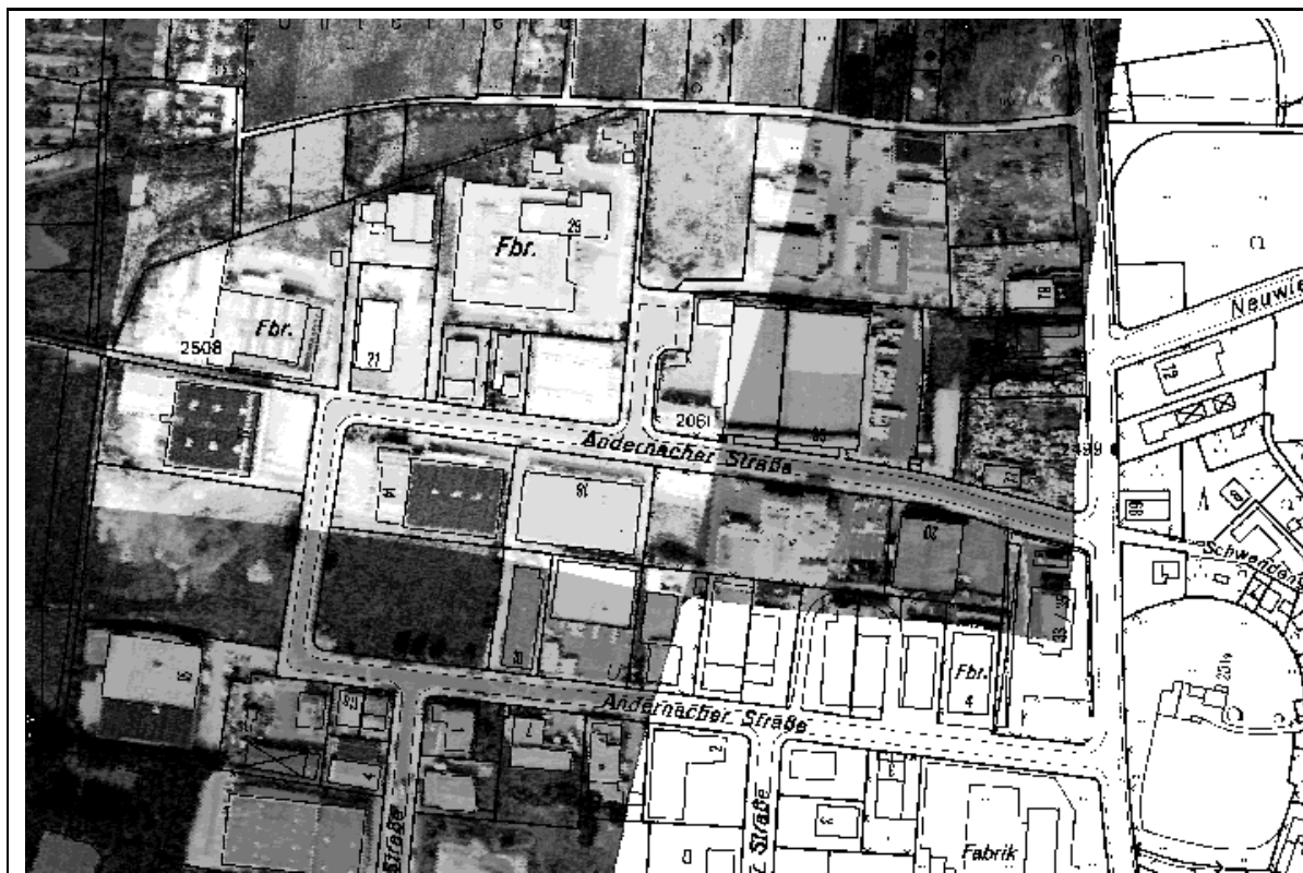
Abbildung 2: Beispiel für eine Scanner-Aufnahme aus 300 m Höhe, Nadir-Bodenauflösung ca. 0.7 m, registriert auf eine Karte des Maßstabs 1:5000. Das Meßtischblatt sowie eine Aufnahme von 1991 und eine von 1992 wurden durch elastische Registrierung zur Deckung gebracht. Die Aufnahmen entstammen verschiedenen Flugstreifen, und der helle Bildbereich zeigt die Überlappung.
