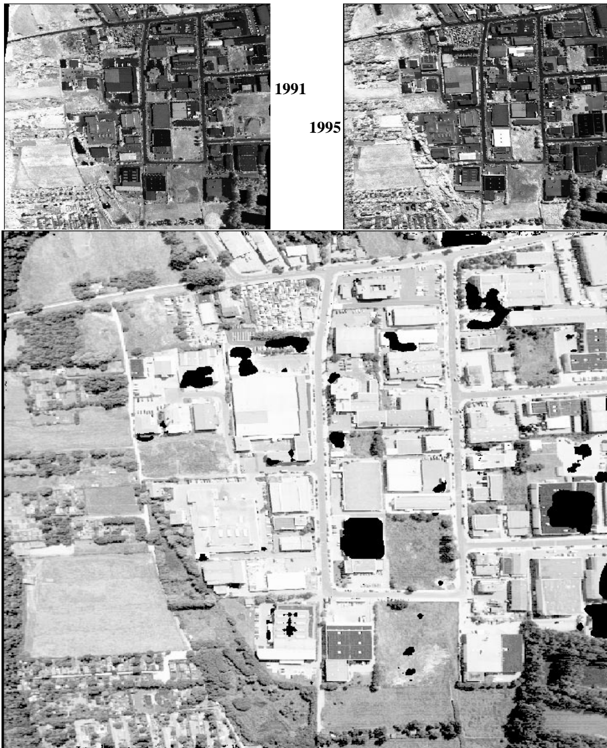
Abbildung 5: Beispiel für Änderungsdetektion: Eine Aufnahme von 1991 (oben rechts, verkleinert) wurde auf eine Aufnahme der gleichen Szene von 1995 (oben links) registriert, so daß ein pixelweiser Vergleich möglich wird. Schwarz hervorgehoben sind im Bild unten die Bereiche der größten Änderungen zwischen den beiden Aufnahmen. Viele Änderungen entstammen der Bautätigkeit zwischen 1991 und 1995.
