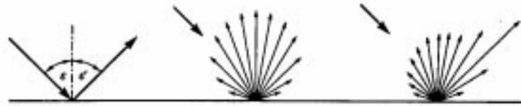
**Abb.8** Spiegelnde, diffuse (Lambert'sche) und gemischte Reflexion an einer Oberfläche
